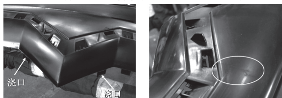
图 17 熔接线外观较差的浇口设计
